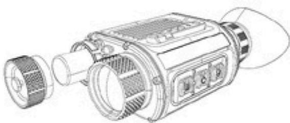
Прибор работает от одного аккумулятора типоразмера 18650. Поверните крышку батарейного отсека против часовой стрелки, чтобы открыть ее. Вставьте аккумулятор в батарейный отсек так, чтобы его плюс был направлен внутрь. После этого поверните крышку батарейного отсека по часовой стрелке, чтобы плотно закрыть ее.
